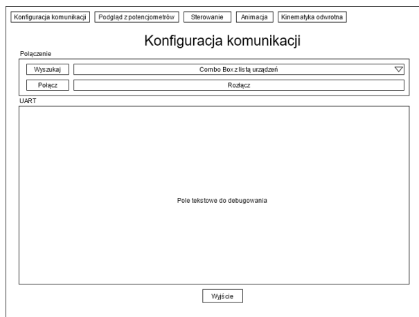
Rysunek 2: Pierwotna wersja okienka do konfiguracji komunikacji z mikrokontrolerem
